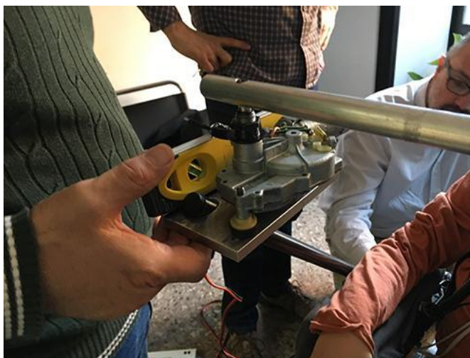
Comprobación del nivelado del soporte horizontal.
